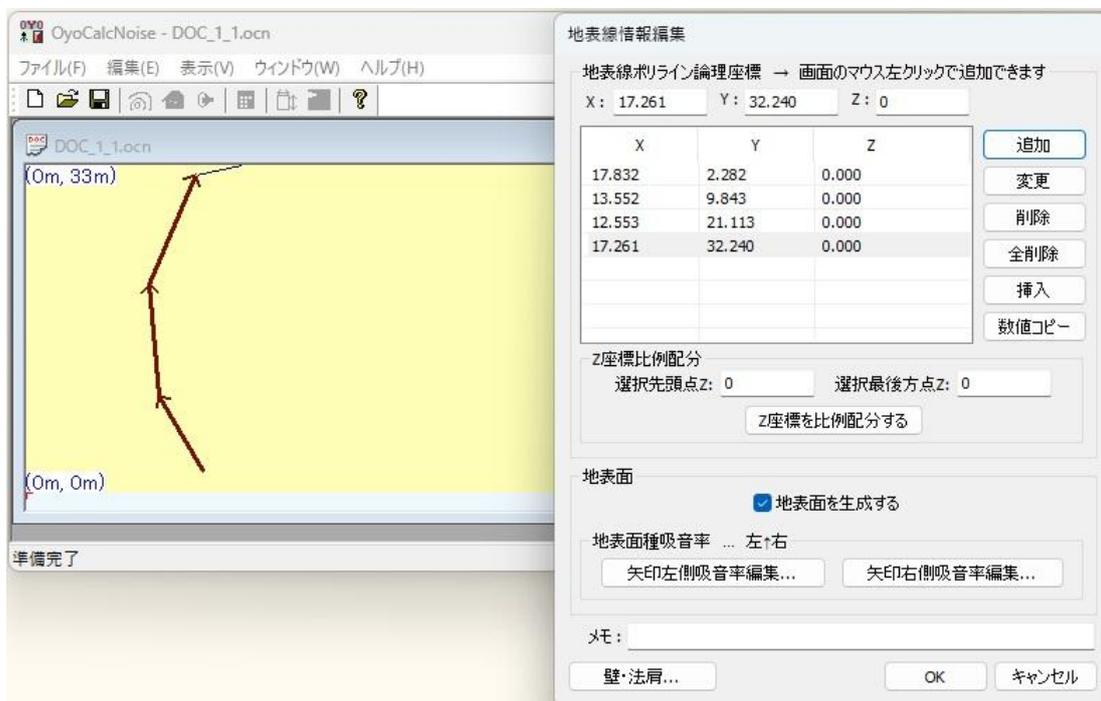
地表線は画面を順にマウス左クリックすることによって設定できます。画面をマウス左クリックするとその XY 座標が「地表線情報編集」画面に反映されて XYZ 座標がリストに追加されます (Z 座標は変更されないので適時指定しておきます)。2 点目から始点と終点を結んだ茶色の矢印が表示されます。矢印の矢側が終点です。なお、2 点目から Shift キー
