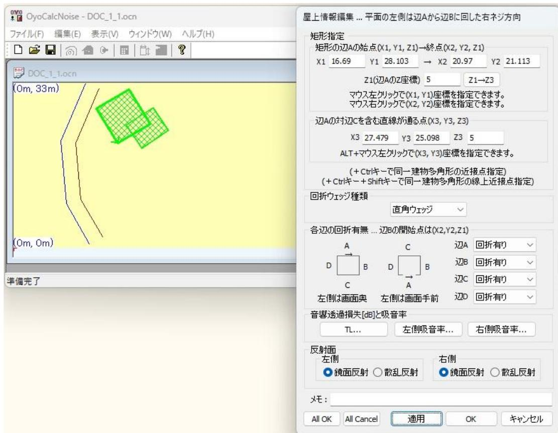
屋上矩形は1辺の両端である(X1, Y1, Z1)と(X2, Y2, Z1)と、対辺の1点である(X3, Y3, Z3)で設定します。マウス左クリックで(X1, Y1)を、マウス右クリックで(X2, Y2)を、Alt キーを押しながらマウス左クリックで(X3, Y3)を指定できます。このとき Ctrl キーを押しながらマウス左クリックすることによって、同一建物形状の端点または交点の最近点を指定できます。(「オフセット」画面が表示され、最近点に加えるオフセット値を指定できます。) また、Ctrl キーと Shift キーを押しながらマウス左クリックすることによって、同一建物形状の边上点を指定できます。
