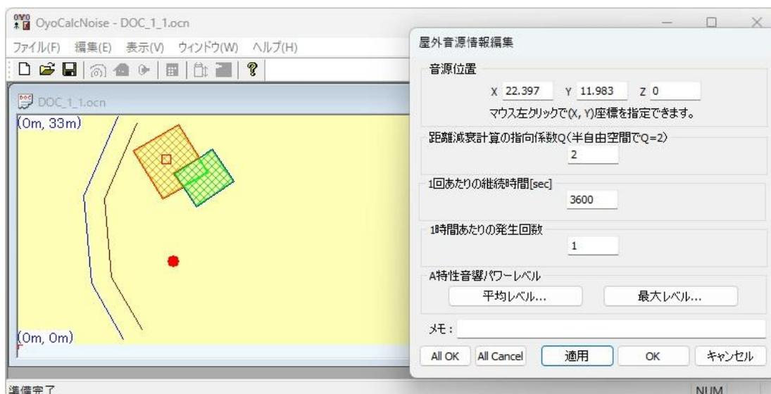
屋外音源位置の座標(X, Y, Z)を指定します。マウス左クリックで(X, Y)を指定できます。
