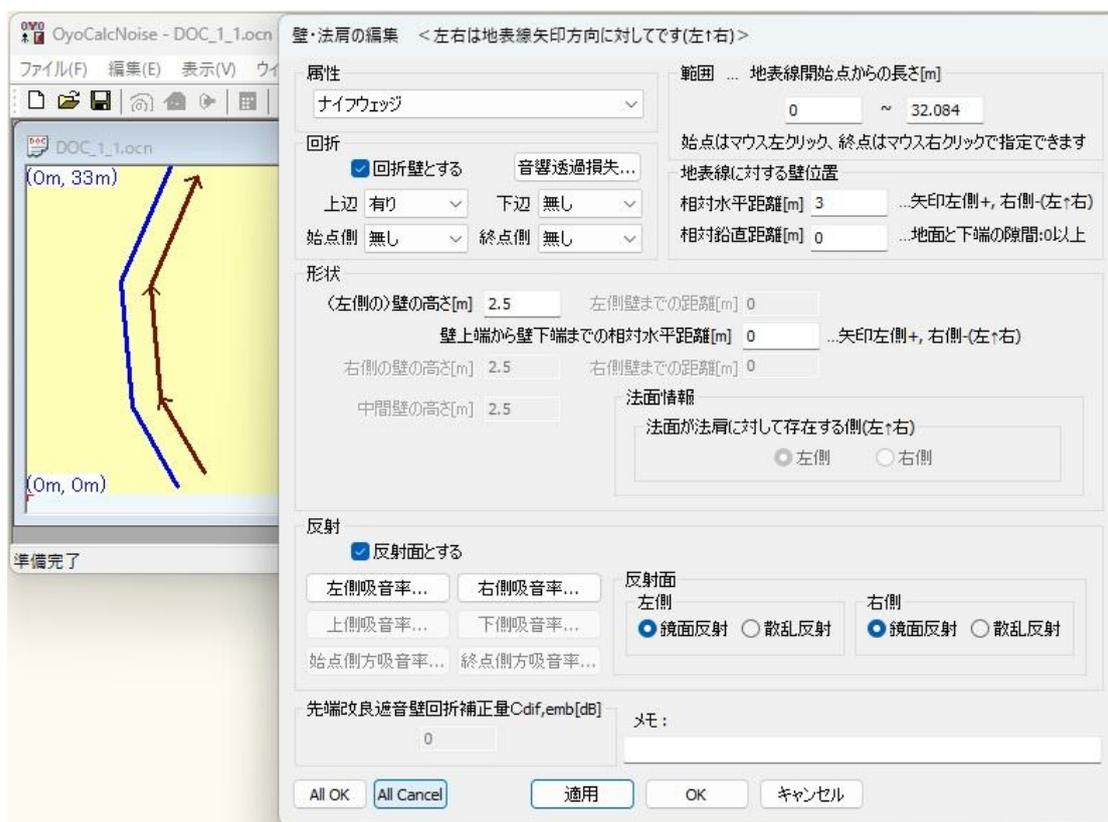
[属性]は「ナイフウェッジ、統一型遮音壁、直角ウェッジ、張り出し型遮音壁 T 型、張り出し型遮音壁 Y 型、張り出し型遮音壁 L 型、張り出し型遮音壁片 Y 型、先端改良型遮音壁、法肩」から選択します。
