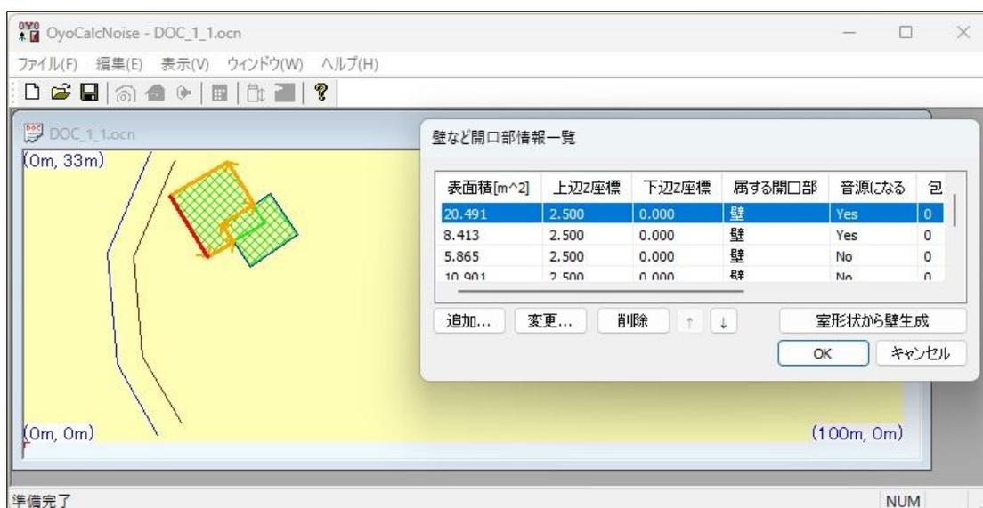
室の形状ポリラインが設定されていれば、[室形状から壁生成]ボタンをクリックすることによって室の壁情報を自動生成できます。上図は[室形状から壁生成]ボタンで自動生成された壁情報が赤（屋外に面した屋外音源となる壁）またはグレー色（非屋外音源）で表示されています。この為、屋外に面した壁と屋内の壁を区別して室のポリラインを設定してください。
