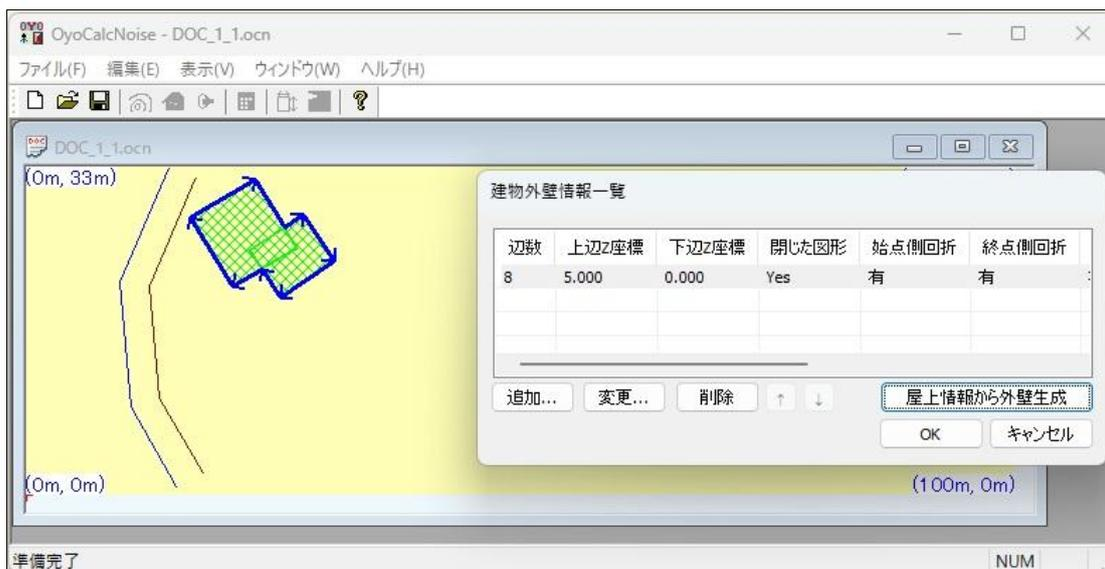
建物の屋上矩形が設定されていれば、[屋上情報から外壁生成]ボタンをクリックすることによって外壁のポリラインが自動生成されます。上図は[屋上情報から外壁生成]ボタンで自動生成された外壁ポリラインが青色で表示されています。但し、外壁が場所によって、吸音率や高さが異なる場合は、自動生成せずに複数の外壁を設定してください。
