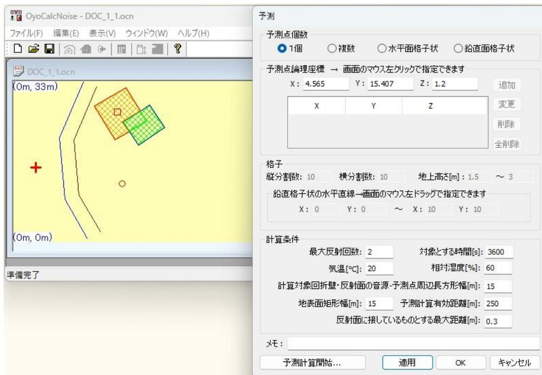
画面をクリックするとその位置のXYZ座標が画面左上に表示され、そのXY座標が[予測点論理座標]の[X][Y]に反映されます。(Z座標は変更されないで適時[Z]座標を指定します)。この[X][Y][Z]座標が[予測点個数]で[1個]を選択している時の予測点の座標となります。[適用]ボタンをクリックすると予測点位置に+が表示されます。
