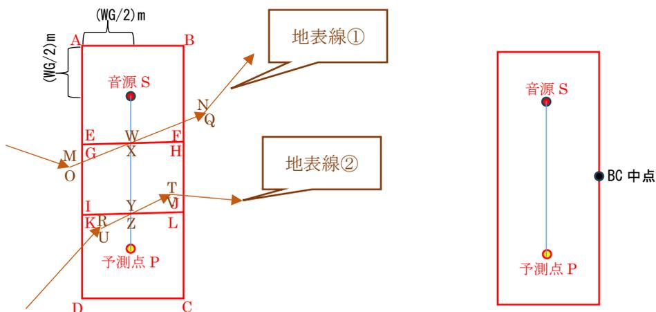
上記矩形 ABCD は、XY 座標で音源 S と予測点 P を結ぶ線分と地表線または法尻線の交点部分(W、X や Y、Z)で複数の矩形(ABFE、GHJI、KLCD)に分けます。この時、音源 S と予測点 P を結ぶ線分と地表線または法尻線の交点を通る地表線または法尻線の両端(M、N や O、Q や R、T や U、V)と、反対側の交点(W、X や Y、Z または音源地表点 S' または予測点地表点 P')から分けられた矩形の平面座標を決定します。例えば、矩形 ABFE の Z 座標は3点 S'、M、N で定義される平面から、矩形 GHJI の Z 座標は3点 O、Q、Y で定義される平面から、矩形 KLCD の Z 座標は3点 U、V、P' で定義される平面から決定します。また、XY 座標で音源 S と予測点 P を結ぶ線分と地表線の交点が存在しない場合は、音源地表点 S' と予測点地表点 P' と BC 中点の地表点 3 点で定義される平面から、矩形 ABCD の Z 座標を決定します。
