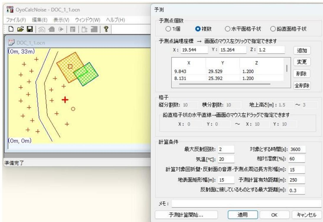
[予測点个数]で[水平面格子状]を選択している時は、[格子]欄の[縦分割数]と[横分割数]と[地上高さ[m]]にしたがって予測点が発生されます。
