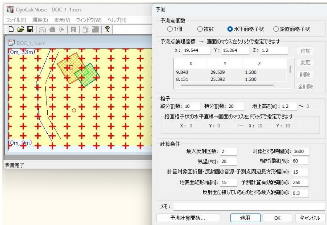
[予測点个数]で[鉛直面格子状]を選択している時は、[格子]欄の[縦分割数]と[横分割数]と[地上高さ[m]]と[鉛直格子状の水平直線]にしたがって予測点が生成されます。
