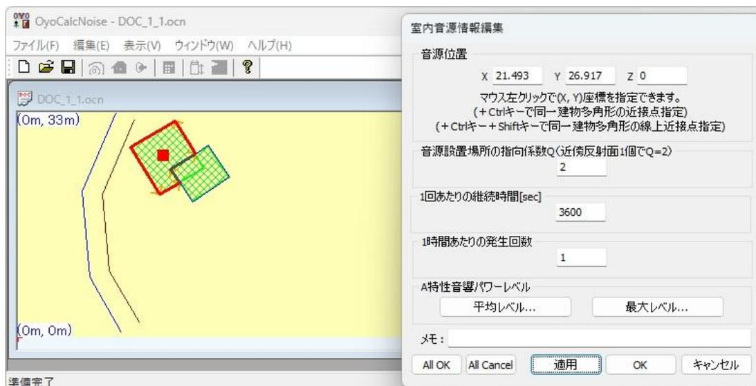
室内音源位置の座標(X, Y, Z)を指定します。マウス左クリックで(X, Y)を指定できます。また、Ctrl キーを押しながらマウス左クリックすることによって、同一建物形状の端点または交点の最近点を指定できます。この時、「オフセット」画面が表示され、最近点に加えるオフセット値を指定できます。また、Ctrl キーと Shift キーを押しながらマウス左クリックすることによって、同一建物形状の辺上点を指定できます。室外の座標でも設定できます。
