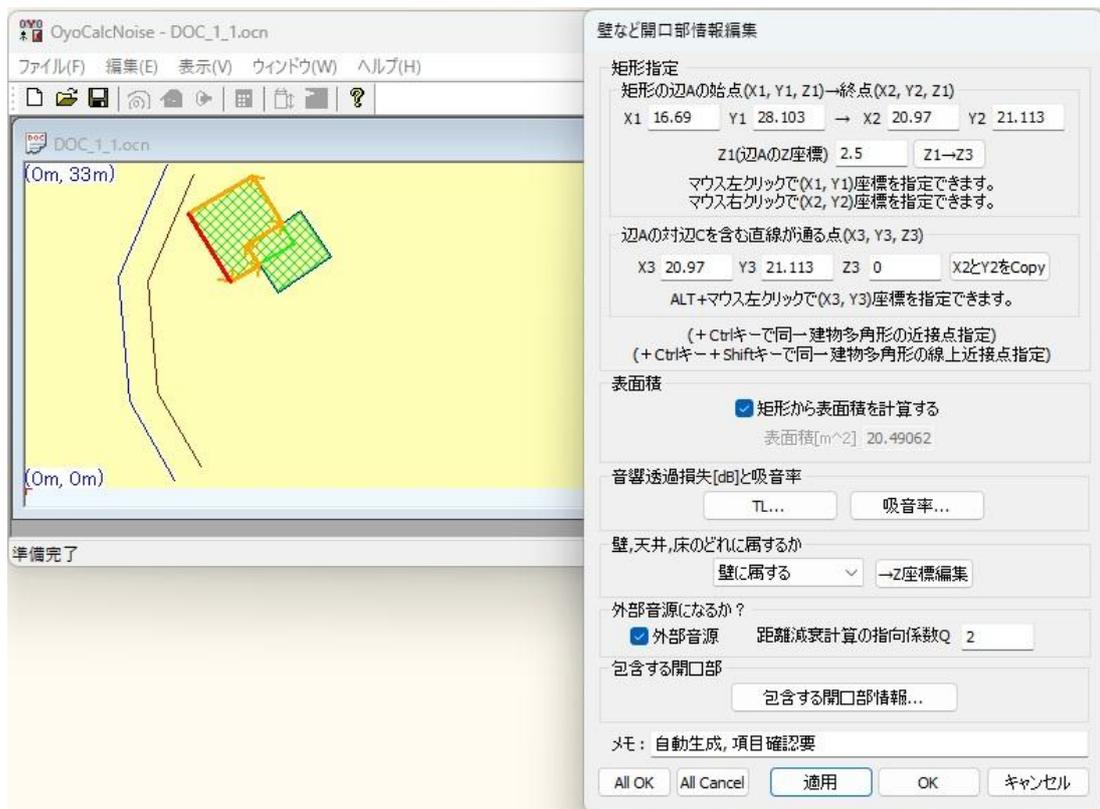
「壁や開口部」は矩形で設定します。矩形は1辺の両端である(X1, Y1, Z1)と(X2, Y2, Z1)と、対辺の1点である(X3, Y3, Z3)で設定します。マウス左クリックで(X1, Y1)を、マウス右クリックで(X2, Y2)を、Alt キーを押しながらマウス左クリックで(X3, Y3)を指定できます。また、Ctrl キーを押しながらマウスクリックすることによって、同一建物形状の端点または交点の最近点を指定できます。この時、「オフセット」画面が表示され、最近点に加えるオフセット値を指定できます。また、Ctrl キーと Shift キーを押しながらマウスクリックすることによって、同一建物形状の辺上点を指定できます。「壁や開口部」矩形は、室形状や外壁と一致させなくても設定できます。
